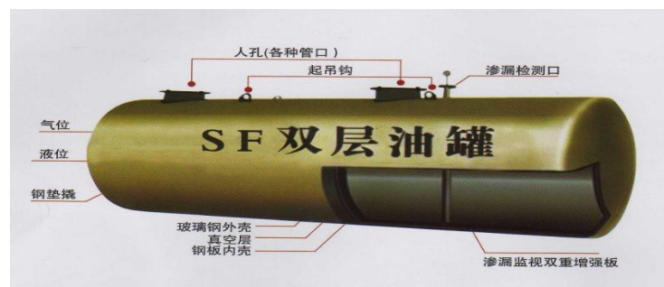
图 2-3SF 双层储油罐结构示意图
